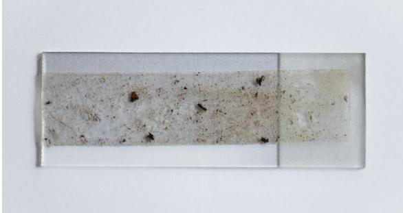
Bild 8: Klebestreifenabklatsch auf Objektträger
